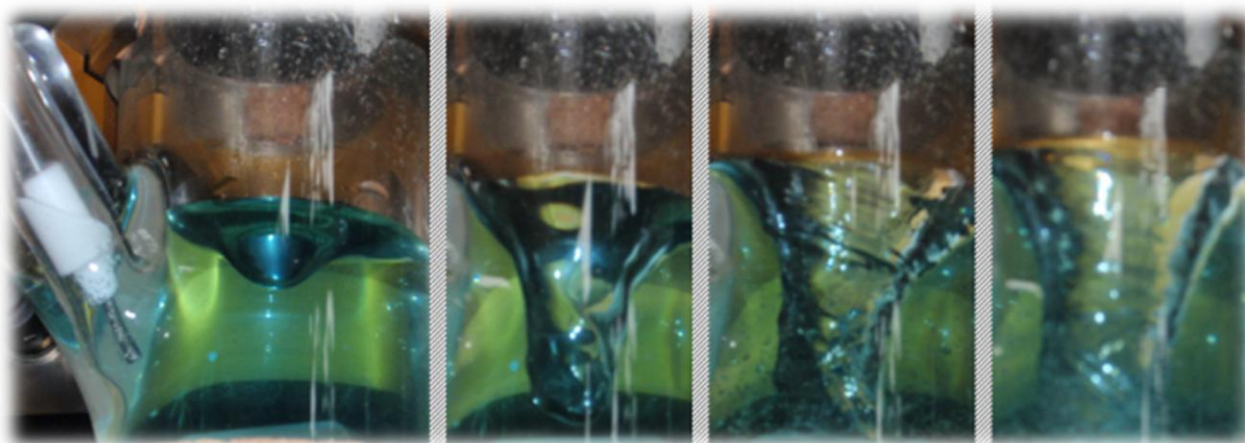
Abb. 4: Rührwirkung auf 60[mL] Wasser; von links 7.5, 15, 25 und 40 [U/sec]
